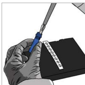
Paso 1 Añadir el tampón de rehidratación
