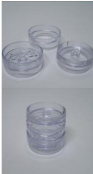
**Figura 7.** Fotos del cassette que contiene el filtro de sólidos en suspensión
